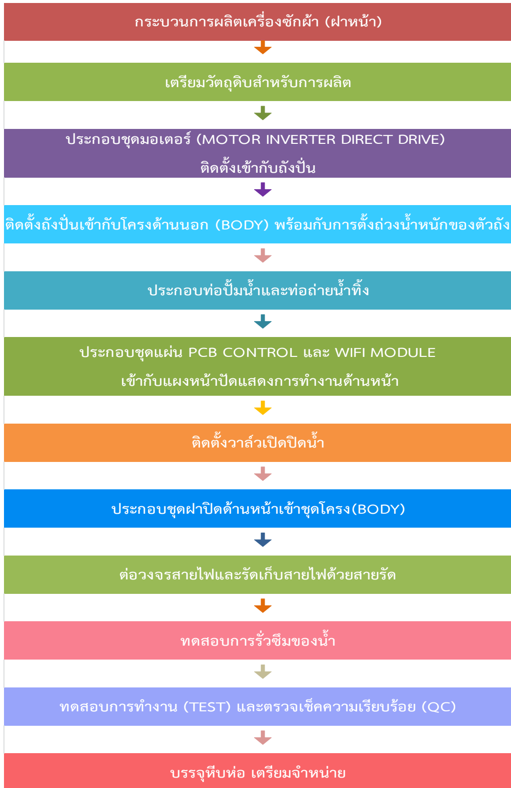
ภาพที่ 3 แสดงกระบวนการผลิตเครื่องซักผ้า (ฝาหน้า)
